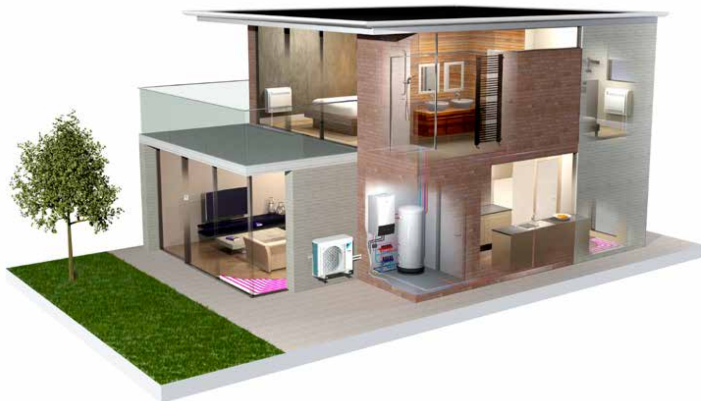
Esempio di installazione con serbatoio acqua calda sanitaria in acciaio inossidabile.
